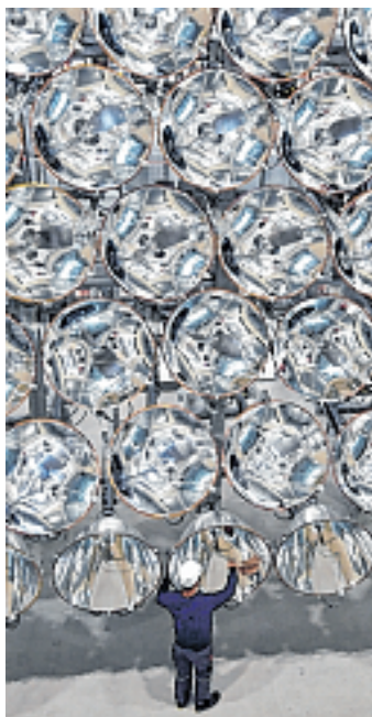
Mit den Riesen-Lampen wird im Labor getestet, ob man aus Sonnenlicht Treibstoff gewinnen kann. Foto: dpa
